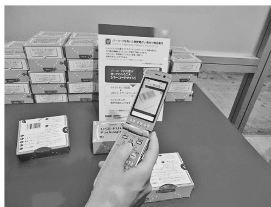
(DNPが開発中の目が不自由な人達が、バーコードから製品情報を読み取ることができるシステム。バーコードの位置は触って分かるようになっている。)
